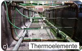
**Abbildung 6.14:** Längs- und Querschnitte mit Positionen der Dehnungsmessstreifen ( $S_i$ ), der Thermolemente ( $T_i$ ) und der faseroptischen Sensoren (FOS<sub>i</sub>) (links); Fotos von FOS, aufgeklebt auf einen Bewehrungsstab (a) und in einer Kapillare (b), und des Messquerschnitts C-C (c), Maße in [mm]
