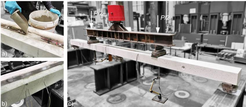
**Abbildung 6.15:** Verstärkungsprozess: Einlegen von Bewehrungsstäben und Verfüllen der angefeuchteten Nut mit Mörtel (a), Aushärtung des Mörtels (b); Belastungstest des verstärkten Balkens (c)
