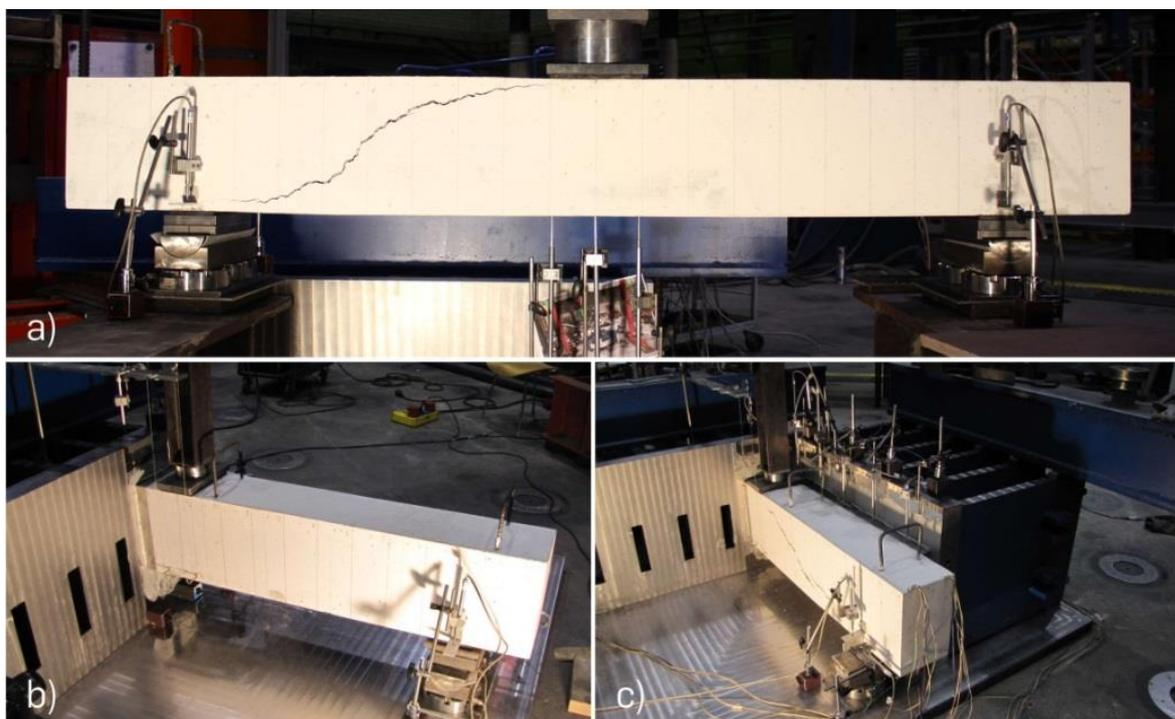
**Abbildung 4.3:** Versuchsaufbauten für die Untersuchung der ungewollten Versteifungseffekte am Probekörperanschluss a) Referenzvollbalken, b) Halbbalken und c) Plattenstreifen
