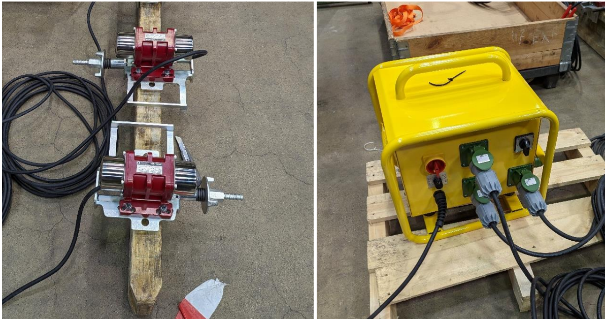
Schalungsrüttler von Vibratec mit zugehörigem Frequenzumformer
