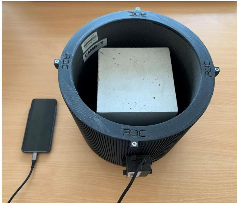
Induktionsgerät CAMBOT mit 150 mm Würfel
